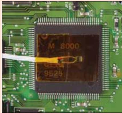
Il sensore autoadesivo è ideale per il posizionamento "mirato" su superfici curve o piane. Una volta in posizione, può essere usato "così com'è" per misurare temperature in applicazioni quali macchine utensili, prodotti elettronici, strutture o altri luoghi in cui è necessario monitorare e controllare le temperature.
