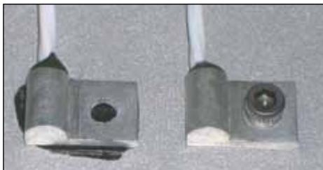
Applicazione tipica in resina epossidica; consultare i cementi e resine epossidiche OMEGABOND®.
