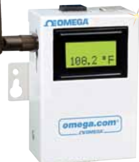
UWTC-REC2-D con uscita analogica e display.
