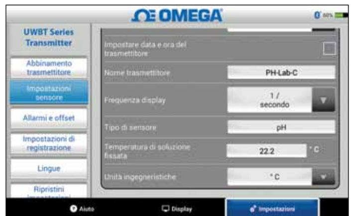
Figura 3: Inserimento della temperatura fissa della soluzione
