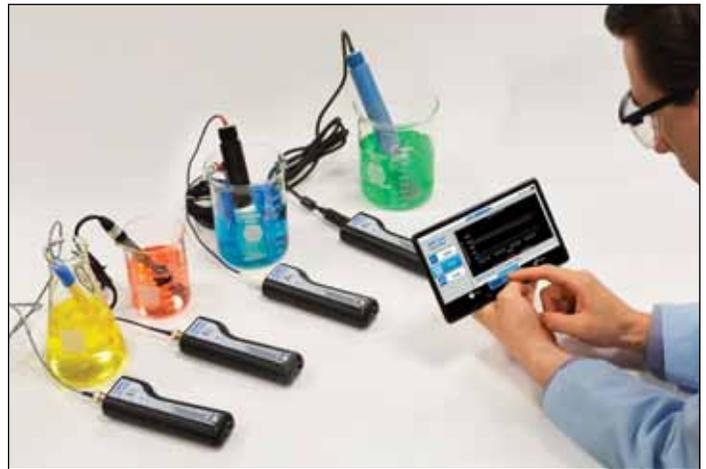
Figura 2: Quattro trasmettitori UWBT-PH collegati a un solo tablet
