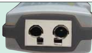
Connettore universale, mostrato nelle dimensioni reali. La struttura del connettore universale accetta i connettori per termocoppie standard e mini.
