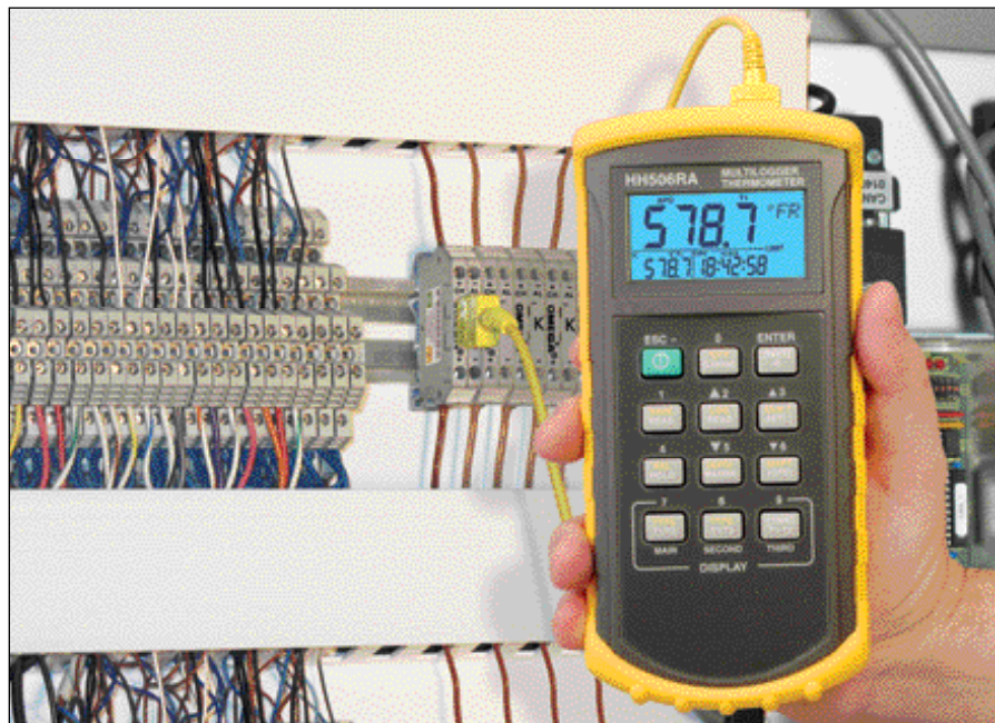
Mostrata con cavo RECK1-10 e registratore dati/termometro HH506RA, con interfaccia RS232C.
